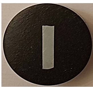
Рис. 2. Кольцевой образец из RS-300: 1 - после деформирования и вырезки заготовки для шлифа; 2 – шлиф для исследования макро-микроструктуры
