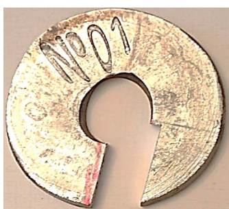
Рис. 2. Кольцевой образец из RS-300: 1 - после деформирования и вырезки заготовки для шлифа; 2 – шлиф для исследования макро-микроструктуры
