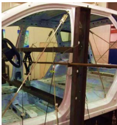
Рис.7. Натурные испытания на жесткость кузова
