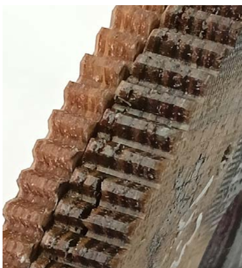
Рис. 8. Ведомое колесо из композиционного материала ( h=5 и 8 мм)
