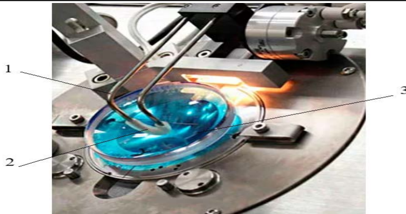
Рис. 2. Внешний вид полировочного устройства оптических поверхностей: 1 – металлический щуп; 2 – исследуемый объект; 3 – оптическая поверхность
