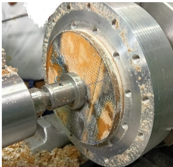
Рис. 4. Приспособление для токарной обработки – планшайба с поджатием задним центром
