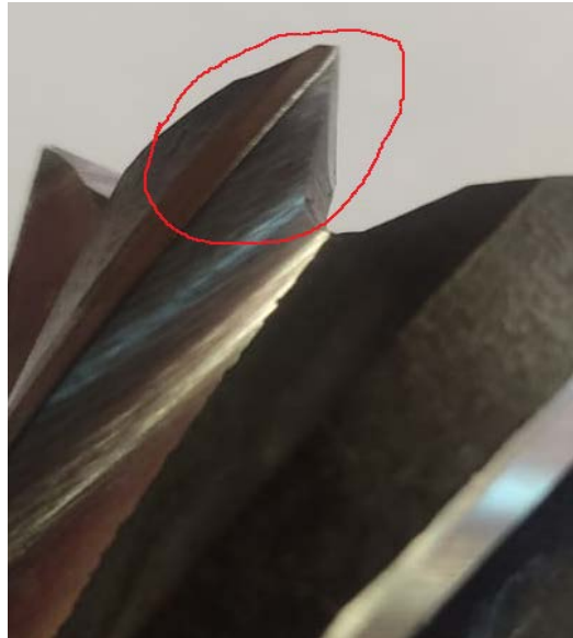
Рис. 3. Износ режущей кромки инструмента после фрезерования
