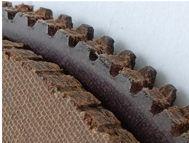
Рис. 1. Дефект в виде истирания зубчатого венца на ведомом колесе узла масляного насоса
