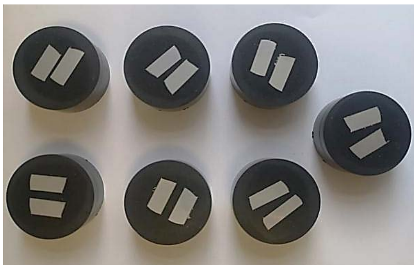
Рис. 4. Шлифы для исследования на сканирующем зондовом микроскопе СММ-2000: первый ряд: 14-15; 04-05; 06-07; второй ряд: 12-13; 08-09; 02-03; средний 10-11
