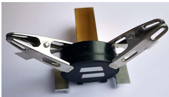
Рис. 5. Специальный держатель образцов
