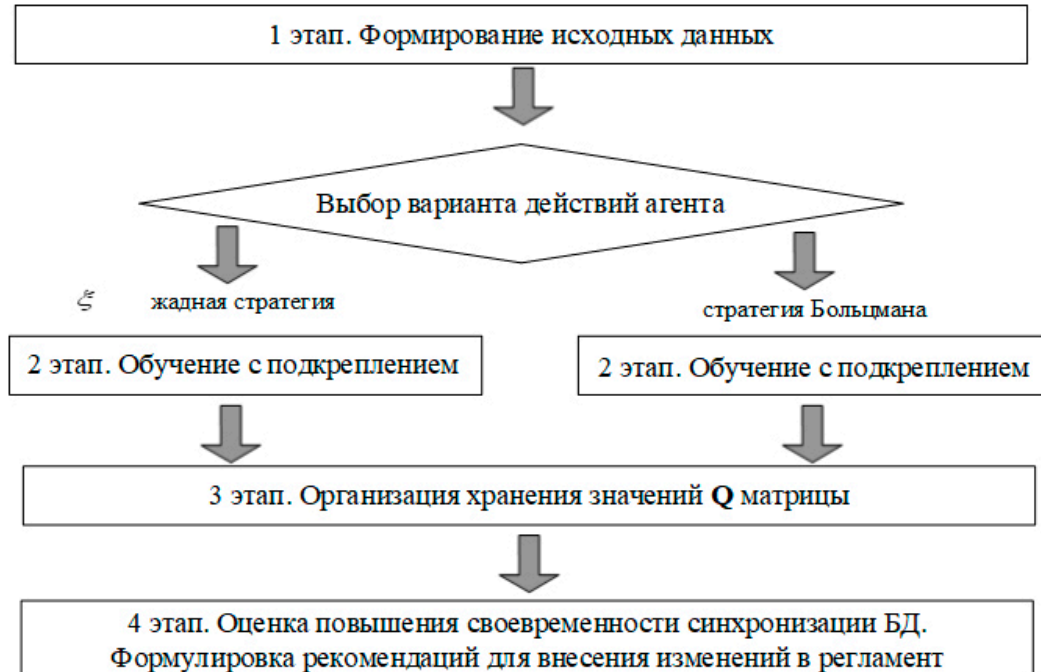
Рис. 1. Этапы методики повышения своевременности синхронизации баз данных автоматизированных систем специального назначения
