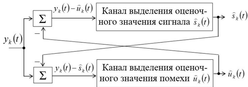
**Рис. 3. Обобщённая схема устройства обработки смеси сигнала и помехи**
