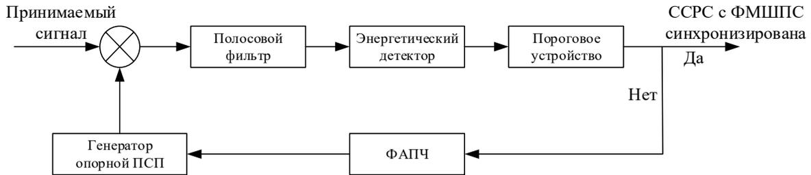
**Рис. 3. Структурная схема системы синхронизации для ССРС с ФМШПС**
