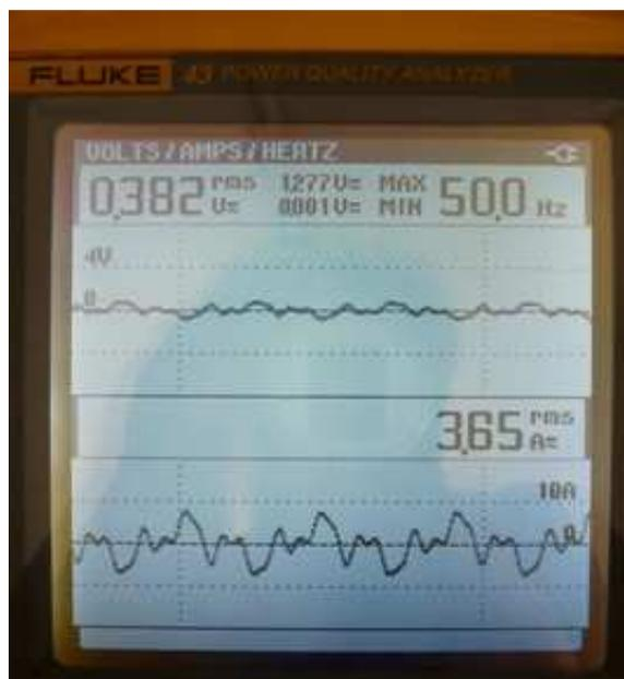
**Рис. 3. График тока и напряжения в нулевом рабочем проводнике при подаче сигнала сложной формы**
