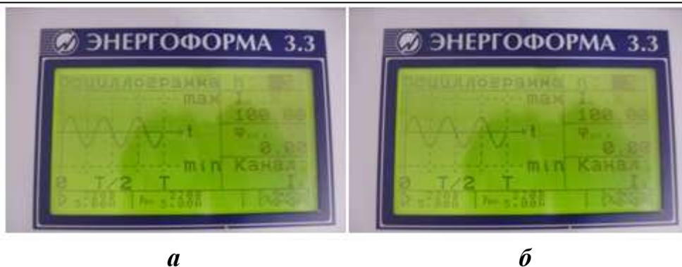
**Рис. 2. На выходы источника подается ток синусоидальной формы:**
