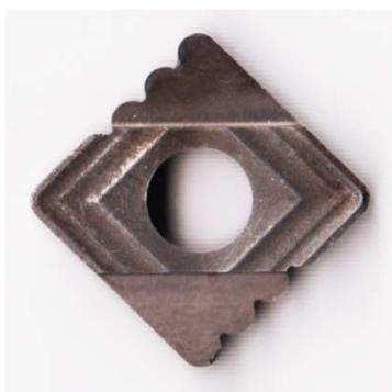
**Рис. 1 Экспериментальная многоступенчатая режущая пластина SNMG 190616 с дискретным исполнением режущей кромки на трех ступенях**
