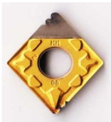
**Рис. 4. Экспериментальная многоступенчатая режущая пластина SNMG 190608 (-ММ) с двумя ступенями с плоской передней поверхностью и с передней поверхностью с индексом ММ**
