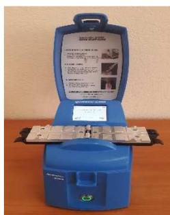
**Рис. 2. Вискозиметр SpectroVisc Q3000**
