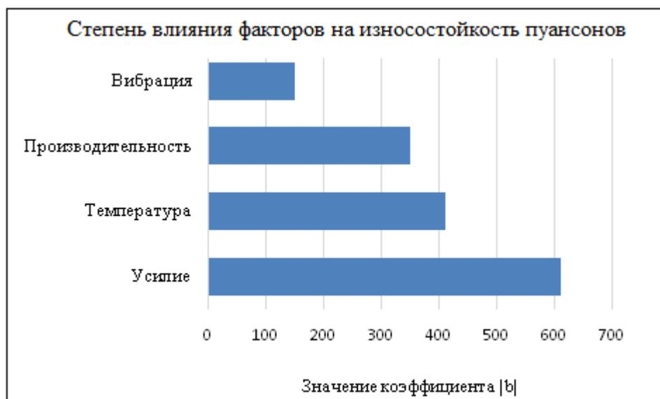
**Рис. 5. Степень влияния факторов на износостойкость пуансонов**
