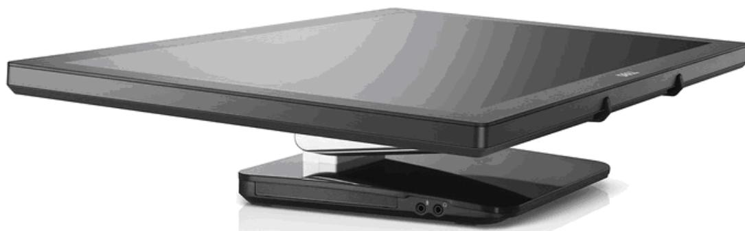
**Рис. 5. Высокоразрешающий ЖК-монитор в горизонтальном положении (функция съемочного стола)**
