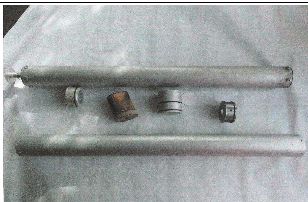
Рис. 6. Устройство МШ.00.010 в собранном и разобранном виде
