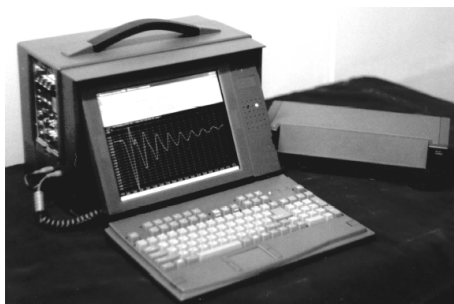
Рис. 1. Диагностическая установка "Импульс-8С" для дефектографирования обмоток трансформаторов методом частотного анализа
