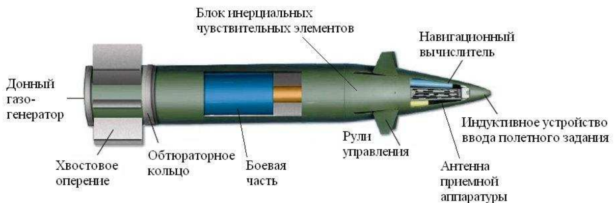
Рис. 1. Устройство снаряда Excalibur M982 Block I
