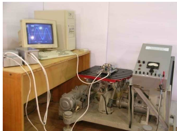
Рис. 3. БИЧЭ на динамическом стенде
