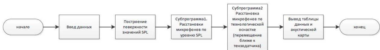
Рис. 3. Структурная схема алгоритма программы автоматизации расстановки микрофонов для акустических испытаний
