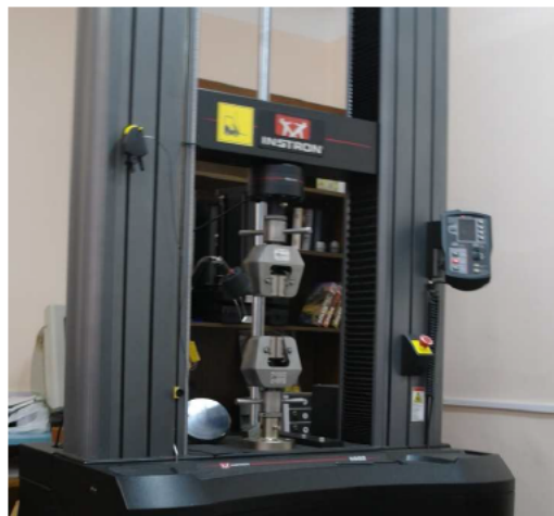
Рис. 1. Машина для испытания на растяжение фирмы Instron
