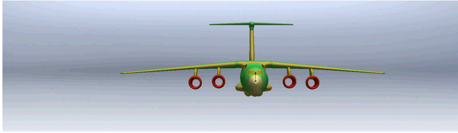
Рис.2. Пример экспресс акустической карты Ил-476, выполненной с помощью разработанного программного комплекса
