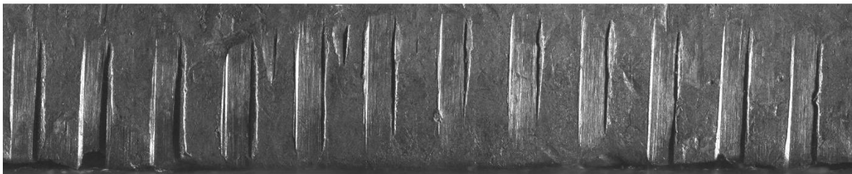
Рис. 2. Фоторазвертка ведущей (боковой) поверхности пули, выстреленной из 4,5 мм пневматической винтовки «Хатсан» модель 70 (АБИС «Арсенал»)
