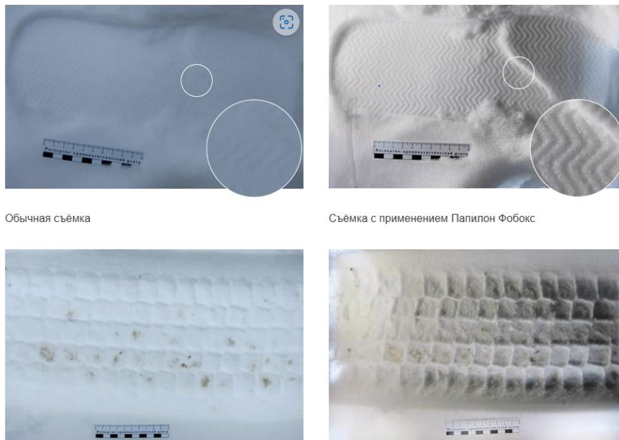
Рис. 1. Следы обуви и транспортного средства в условиях обычной фотосъёмки (слева) и с помощью устройства «Папилон ФоБокс» (справа)
