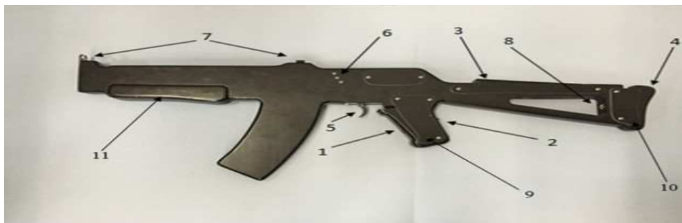
Рис. 4. Схема имитатора с датчиками контроля навыков стрелка: 1 - пистолетная рукоятка с упругоподвижной планкой; 2 - контактный выключатель электронного устройства индикации; 3 - планка усилия нажима щеки на приклад; 4 - планка усилия нажатия в плечо; 5 - спусковой крючок; 6 - трехцветный индикатор; 7 - прицельные приспособления; 8 - винт регулировки фиксатора усилия, оказываемого щекой стрелка на гребень приклада; 9 - винт регулировки фиксатора усилия, оказываемого на планку пистолетной рукоятки; 10 - винт регулировки фиксатора усилия, оказываемого прикладом на плечо стрелка; 11 - цевье
